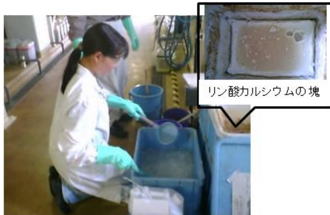
保護眼鏡と手袋を着用し、手作業で薬品を投入・攪拌する。
