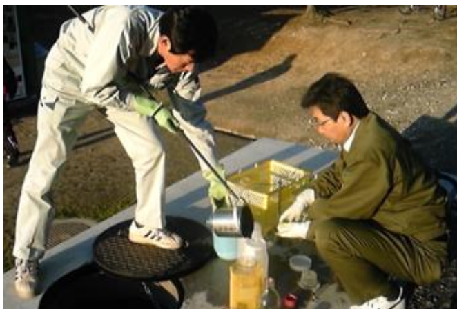
専門業者による水質検査。下水道法で定められた排出基準を満たしているか、厳しくチェックされる。
