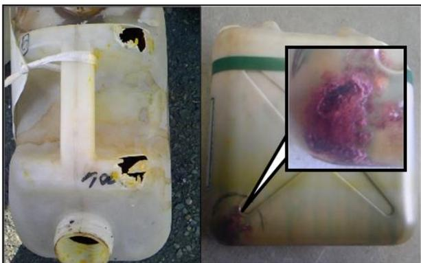
使用期限を越えて使用したため、破損したポリタンク
