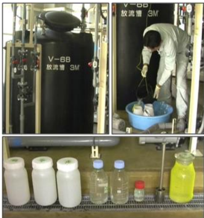
廃液の処理水を貯留する『放流槽』(左上)から水を採取し(右上)、水質を検査する。下は採取された水一式。
