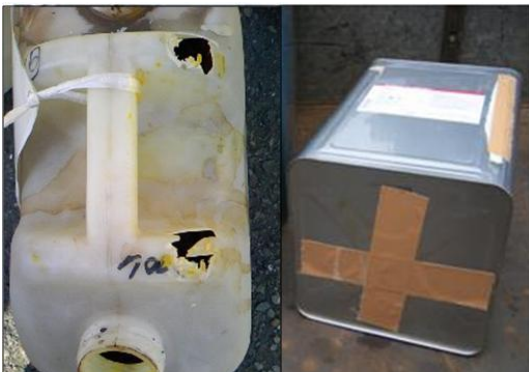
これまでに発生した液漏れ（容器破損）の例
